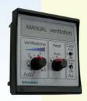
Il modulo Tiny-Man permette il funzionamento dell'impianto in modo manuale escludendo il funzionamento della centralina. Attiva le 5 velocità di ventilazione, i tre stati del riscaldamento (+Gas/-Gas/Off), il Coooling (On/Off) e l'allarme (On/Off)
